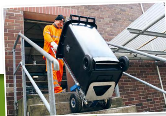
Elektrisch betriebene Treppensteiger und Ziehhilfen (Bild nächste Seite) reduzieren körperliche Belastungen
