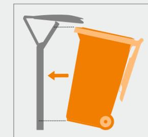
2. Tonne reinfahren, unter der oberen Querstrebe einklinken ...
